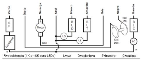
EN CASO DE USAR LEDs: El positivo de éste (patita larga) debe ir conectado al cable azul, que es el común positivo de todos los accesorios.
