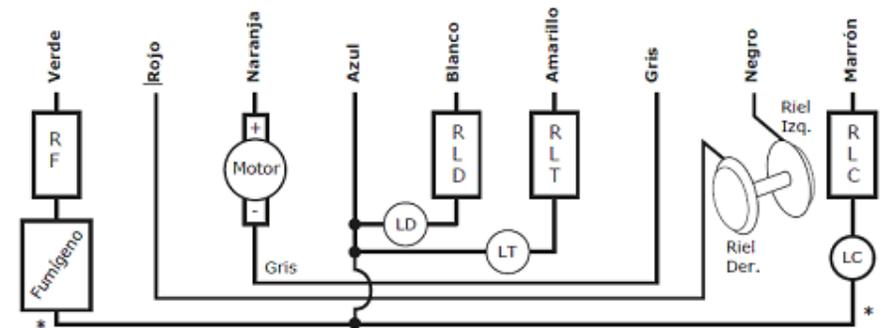
R= resistencia (1K a 1K5 para LEDs) L=luz D=delantera T=trasera C=cabina
